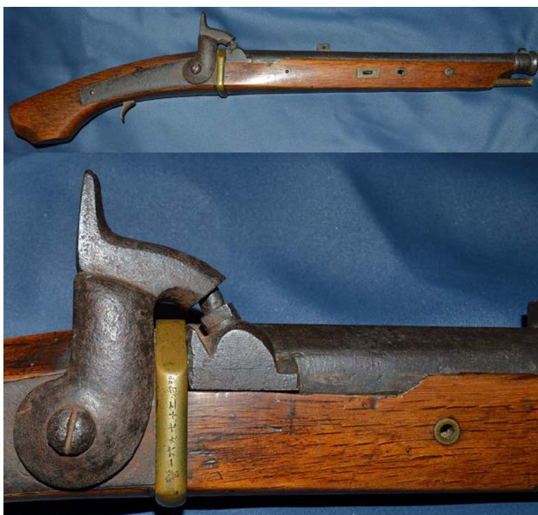
Илл. 3. Один из многочисленных примеров переделки японского фитильного огнестрельного оружия в капсюльное
