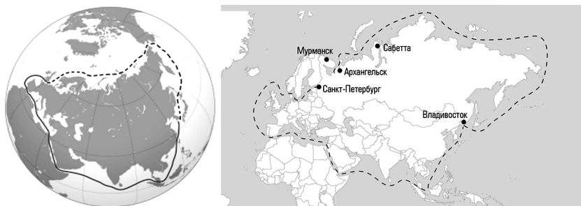
Рис. 2. Сравнение протяженности морских путей по СМП и через Суэцкий канал; Схема российской части СМП. - - - - - Маршрут через СМП. Расстояние от Европы до Владивостока — 14 тыс. км. — Маршрут через Суэцкий канал. Расстояние от Европы до Владивостока — более 23 тыс. км. Источник: Зачем Россия закрывает Севморпуть судам под иностранным флагом. URL: https:// www.ridus. ru/ news/265681 (дата обращения: 16.11.2017); Белоусов А. Порт надежды. URL: http:// expert.ru/ural/2015/19/port-nadezhdy/media/264739/ (дата обращения: 24.11.2017).
